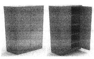
DESCRIÇÃO: Armário alto de aço fabricado todo em chapa #24 com 02 portas de abrir, reforços internos tipo ômega e puxadores estampados na porta no sentido vertical, com acabamento em PVC, contendo 04 prateleiras, sendo 01 fixa e 03 com regulagem de altura do tipo cremalheira, com fechadura cilindrica e pintura eletrostática a pó na cor cinza texturizado. DIMENSÕES MÍNIMAS: 198CM (altura), 90CM (largura), 40CM (profundidade).
